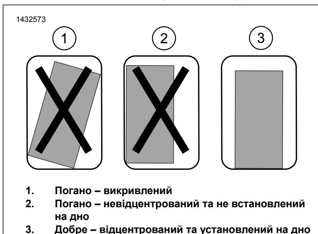
Малюнок 4. Установлення монтажного кронштейна
