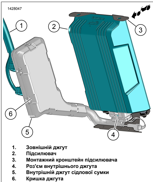
Малюнок 7. Збірка підсилювача лівої сидлової сумки
