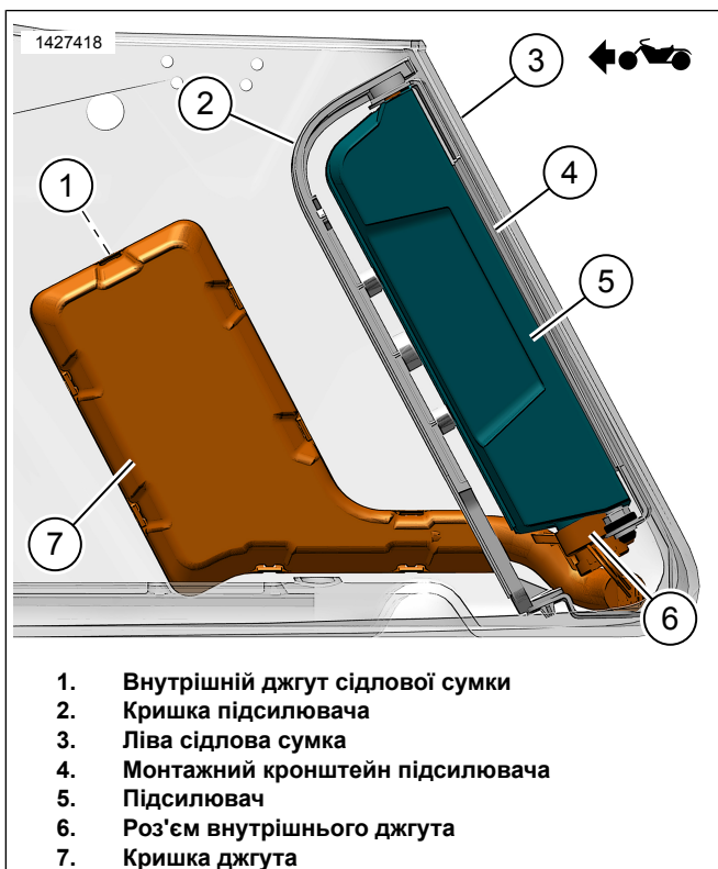
Малюнок 8. Джгут сидлової сумки з підсилювачем
