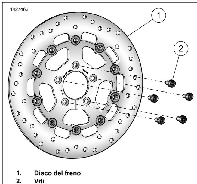
Figura 1. Parti di ricambio: Kit disco del freno posteriore
