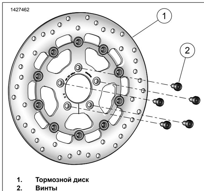
Рисунок 1. Запасные части: Комплекты заднего тормозного диска
