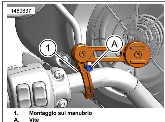
**Figura 2. Installazione dell'attacco del telefono sul semimanubrio sinistro**
