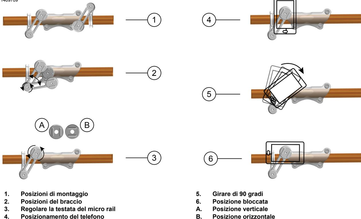
Figura 5. Opzioni di montaggio e posizionamento del telefono
