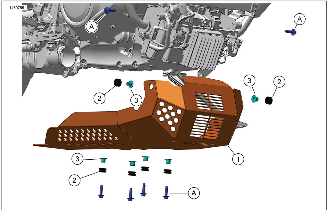
Figure 1. Contenu du kit : Tactical Trekker - Plaque de protection (le montage ne se fait pas dans cet ordre)
