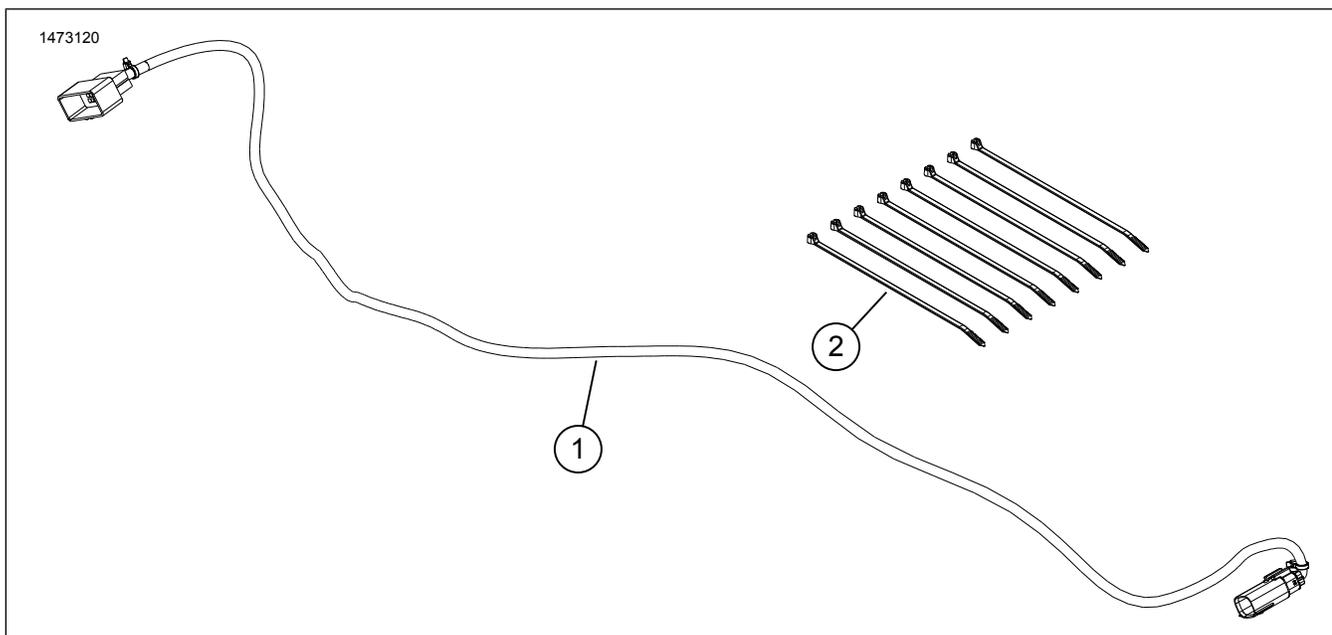
Figura 3. Peças de serviço, Kit de instalação de amplificador
