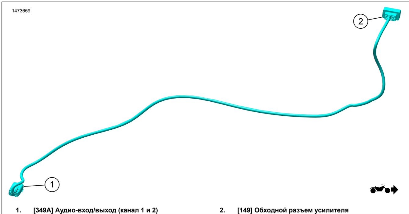
Рисунок 1. Жгут проводов динамика на обтекатель
