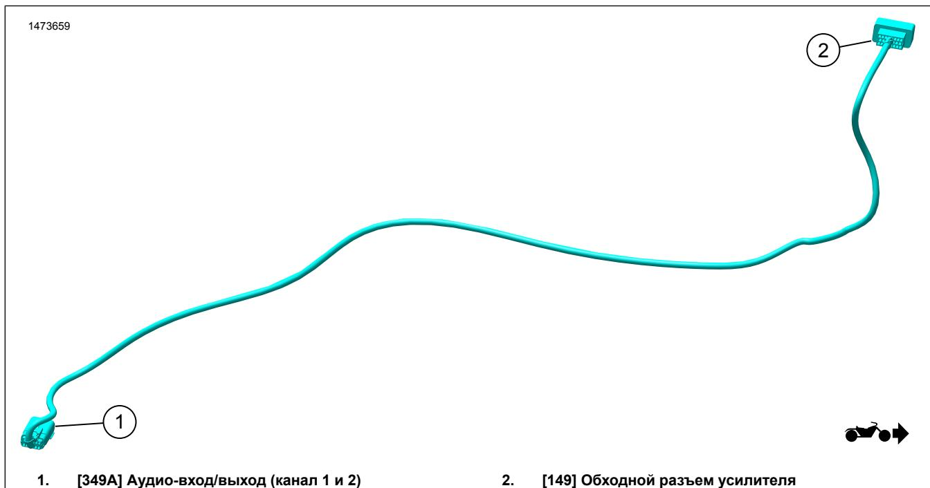
Рисунок 1. Жгут проводов динамика на обтекатель
