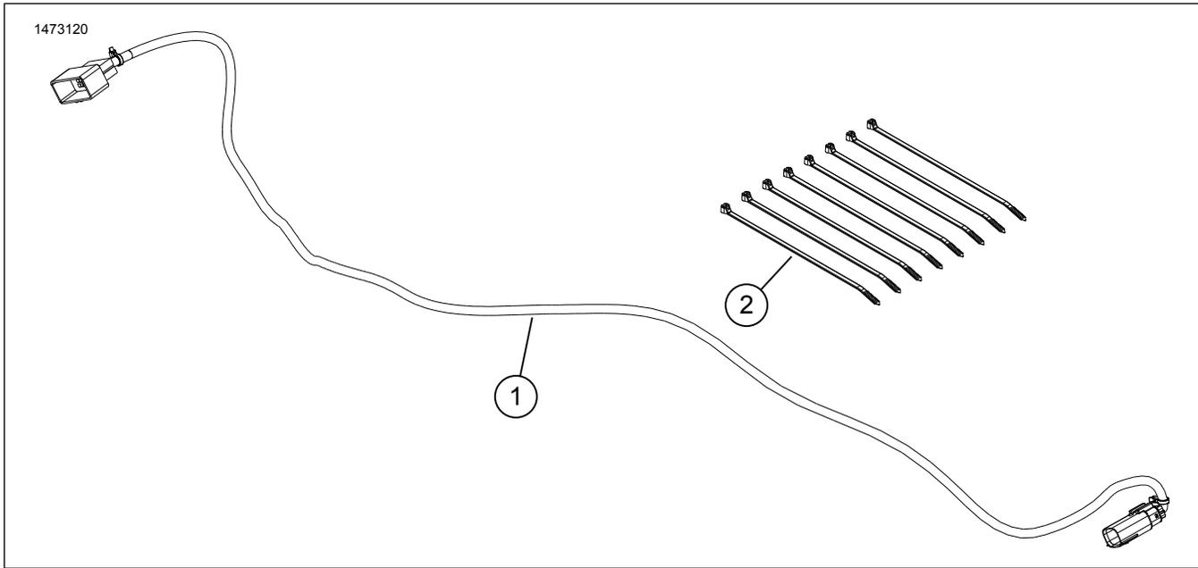
Figura 3. Piezas de servicio, kit de instalación del amplificador
