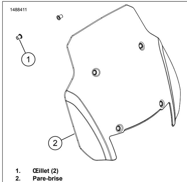
Figure 4. Pièces de rechange - pare-brise Pan America
