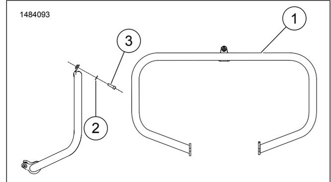
Figura 1. Parti di ricambio: Kit protezione motore
