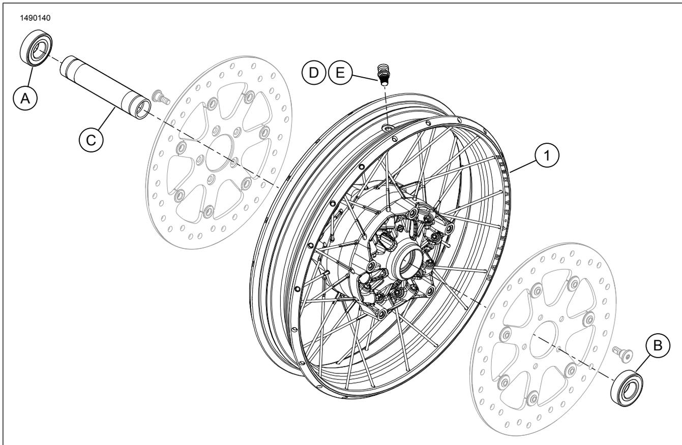
Figure 1. Pièces de rechange : kit de roue avant
