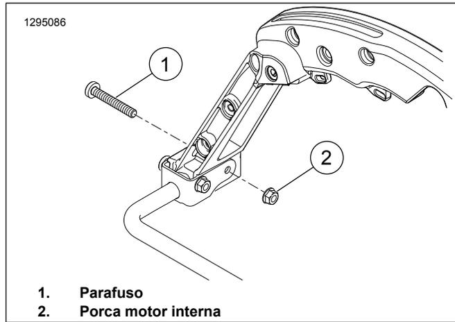
**Figura 6. Remoção do parafuso OE**
