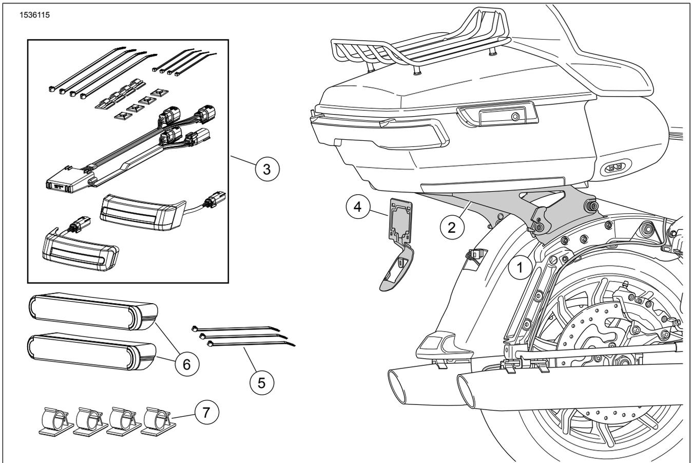
Figura 1. Conteúdo do kit: Suporte de montagem Tour-Pak destacável
