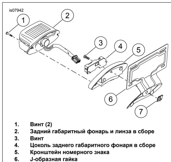
Рисунок 7. Установите кронштейн номерного знака
