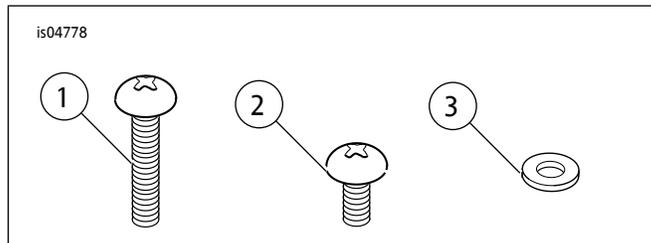
图1。维修零件：开关盒五金件套件
