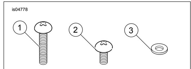
Figura 1. Parti di ricambio: Kit bulloneria per alloggiamento dell'interruttore
