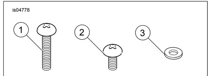
Figura 1. Piezas de servicio: Kit de elementos de sujeción de la caja de interruptores
