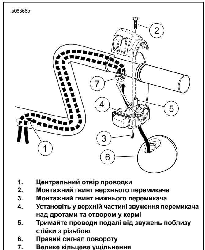
Малюнок 5. Прокладання проводів сигналів повороту і перемикачів через перемикальну коробку
