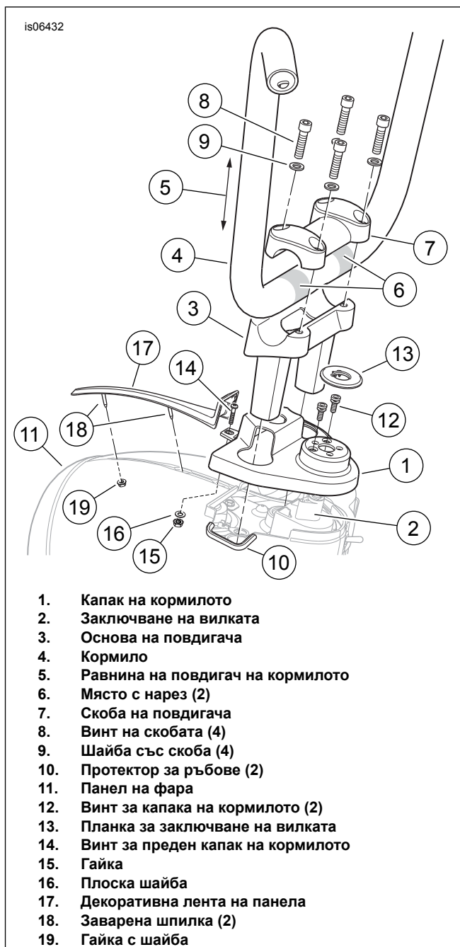
Фигура 8. FLHR Ape Handlebar Riser Configuration
