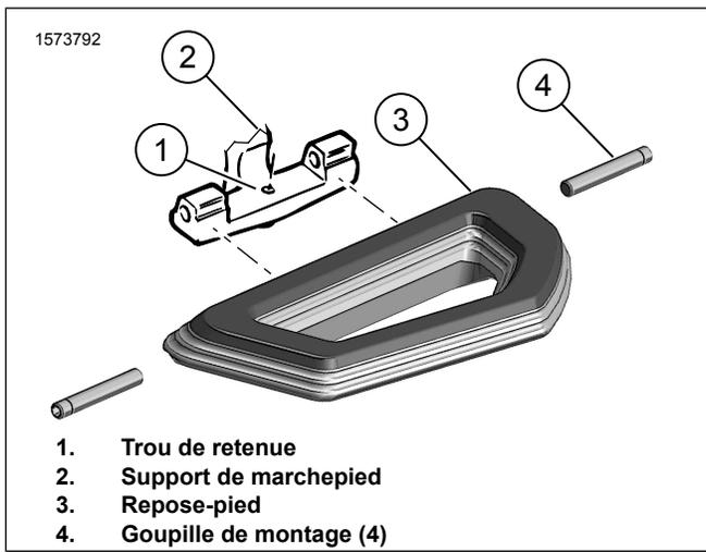
**Figure 2. Support du marchepied et repose-pied**
