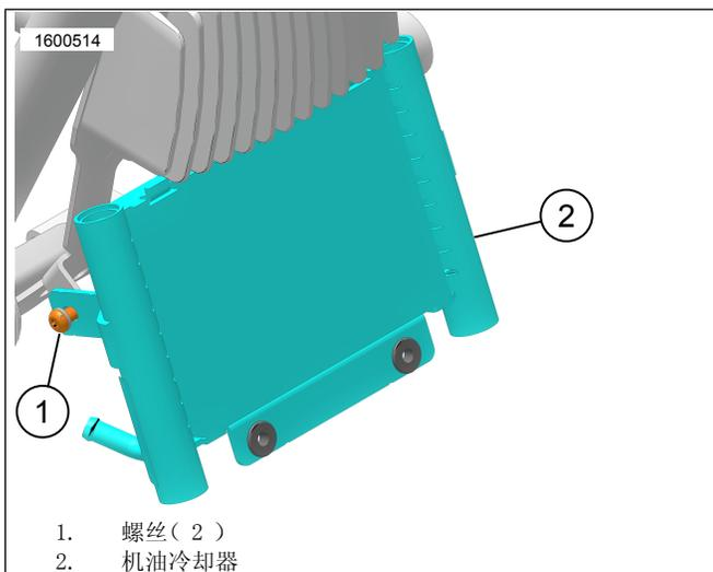
图2。机油冷却器螺丝
