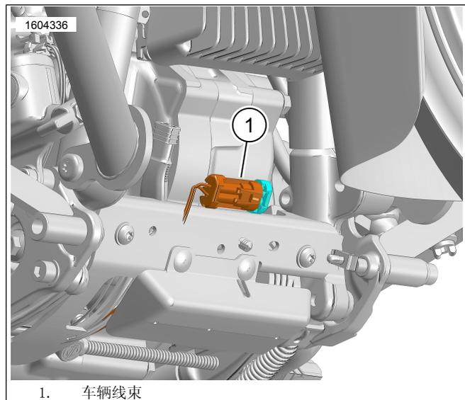
图4。摩托车线束
