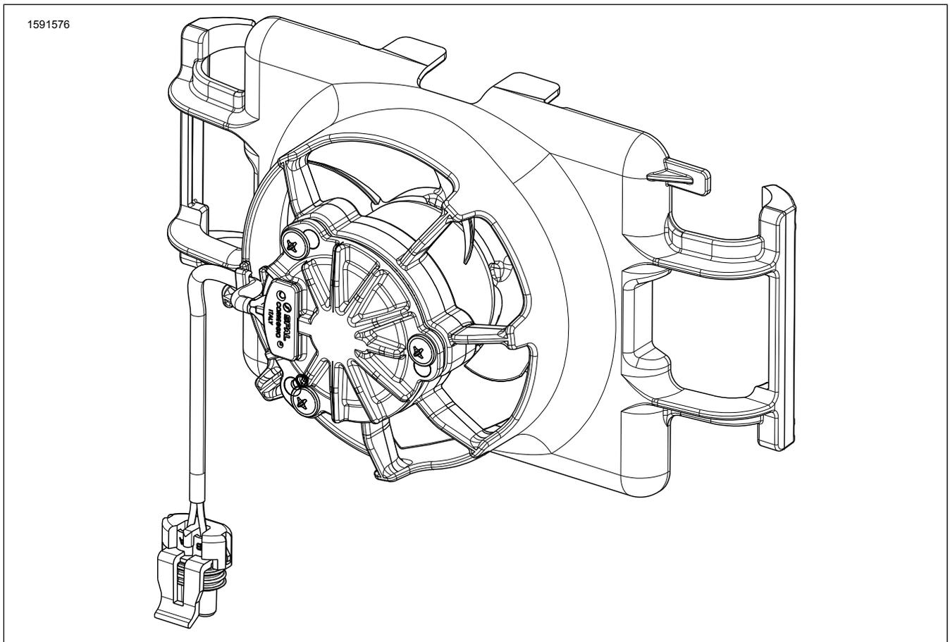
Figura 1. Contenuto del kit: Kit radiatore di raffreddamento dell'olio con ventola del Milwaukee-eight
