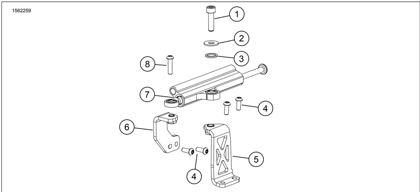
Figure 1. Contenu du kit : Amortisseur de direction
