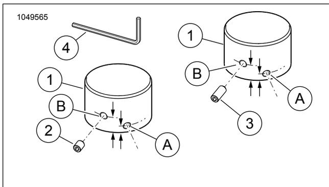
Figura 2. Kit da tampa da porca do eixo dianteiro
