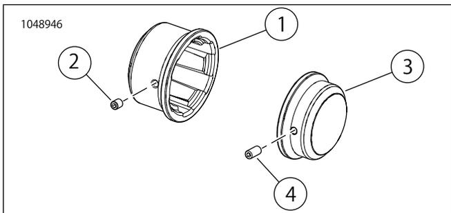
図3。交換用パーツ：ブラスリアアクスルナットカバーキット
