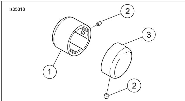
Figura 1. Peças de reposição: Kit da tampa da porca do eixo traseiro
