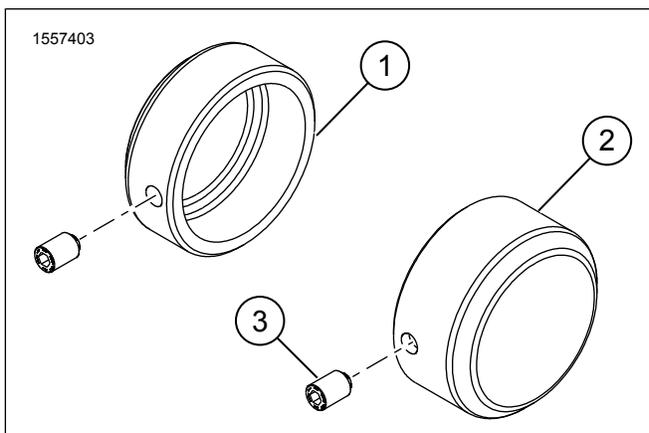
**Figura 6. Peças de reposição: Kit da tampa da porca do eixo traseiro**
