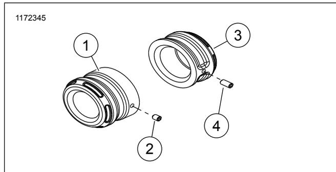
Figura 4. Peças de reposição: Kit de tampas das porcas do eixo traseiro
