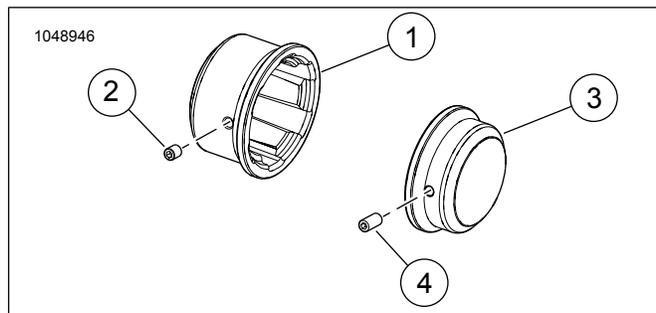
Figura 3. Peças de reposição: Kit de tampas das porcas do eixo traseiro, latão
