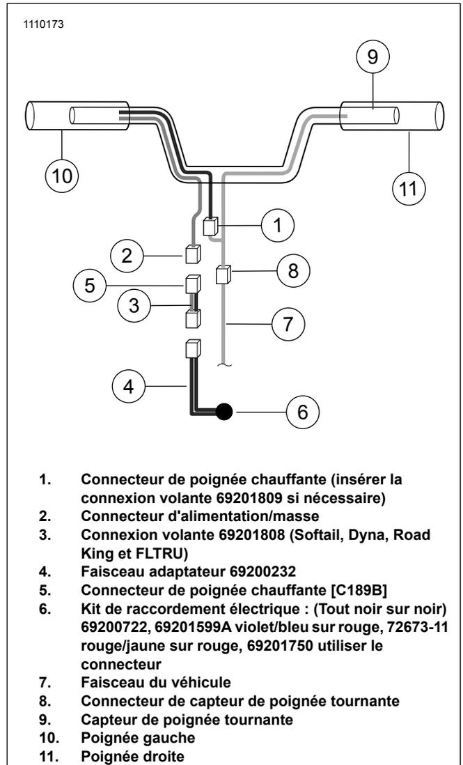
Figure 9. Connexions électriques
