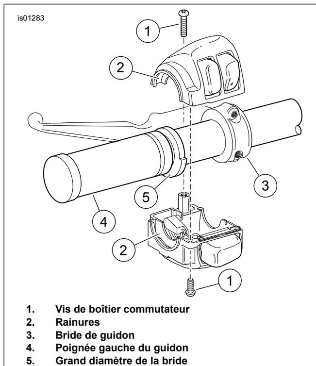
**Figure 4. Boîtier commutateur de gauche du guidon**
