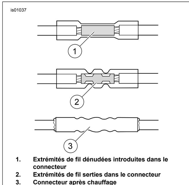
Figure 8. Connexions bout à bout scellées
