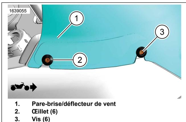
Figure 2. Installation et retrait du pare-brise/défecteur de vent
