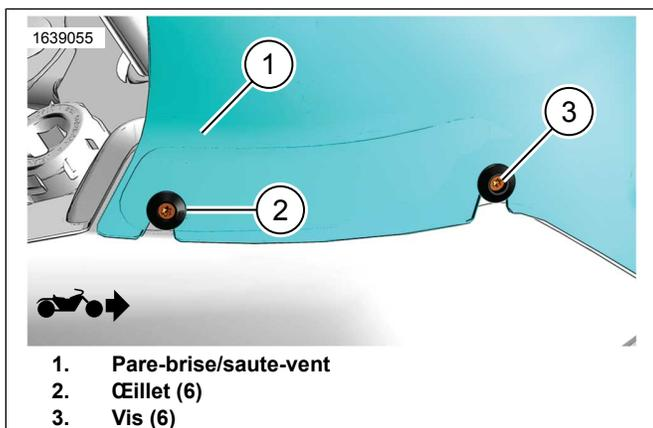
Figure 2. Dépose/installation du pare-brise/saute-vent
