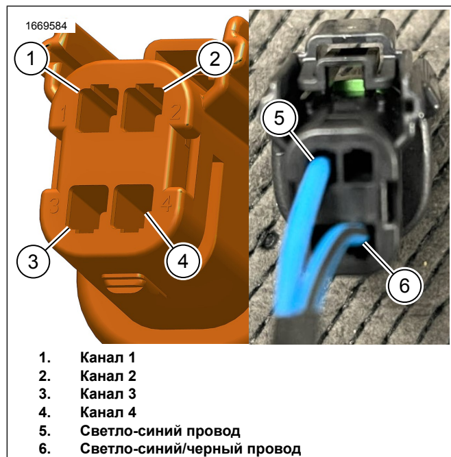
Рисунок 22. Повторная прокладка жгута проводов 69203031
