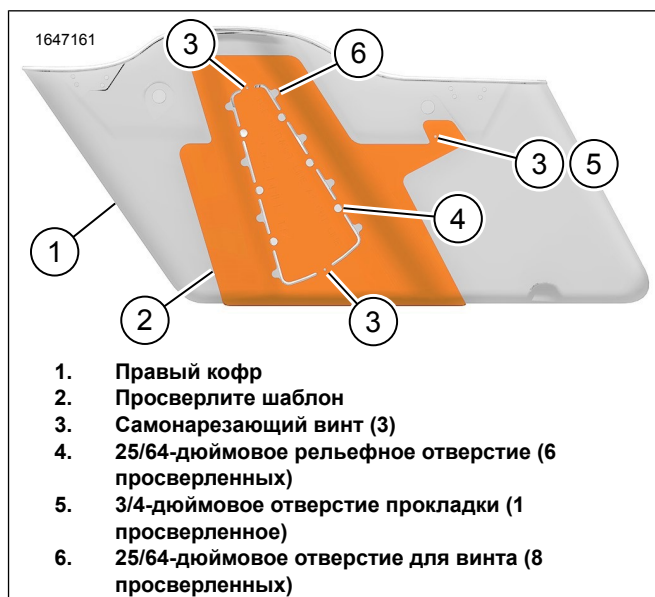
Рисунок 8. Шаблон для сверления правого кофра
