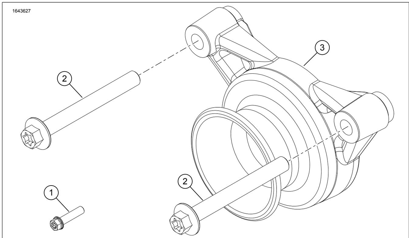
Figure 1. Contenu du kit : Revolution Max - Trompette d'admission
