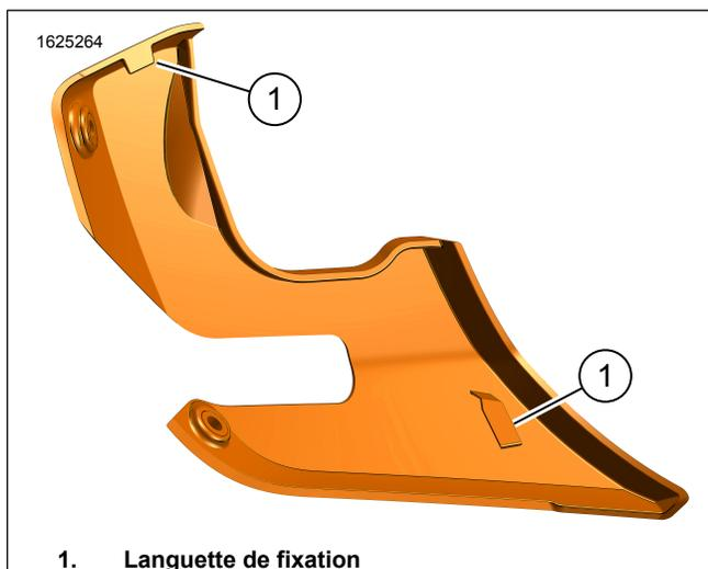
Figure 3. Languettes de fixation
