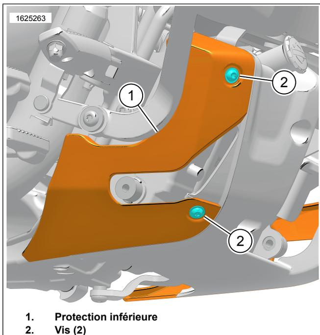
Figure 2. Protection inférieure installée
