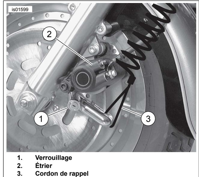
Figure 1. Installation du cadenas de disque
