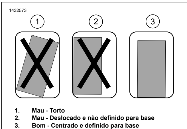
Figura 11. Instalação de suporte de montagem
