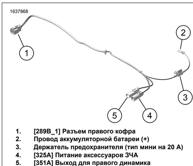
Рисунок 15. Внешний жгут проводов 69202870
