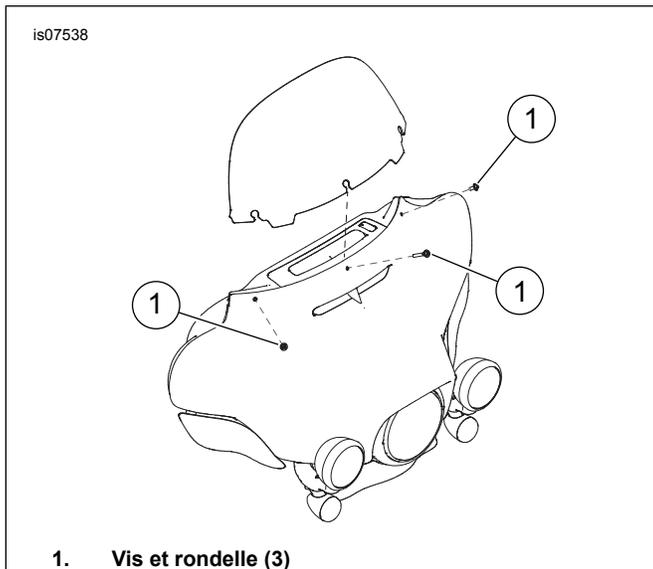
Figure 1. Installation du pare-brise / défecteur de vent
