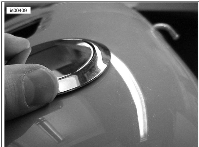
**Figura 2. Determinare la posizione dell'anello di rivestimento**
