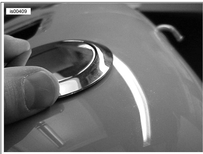
Figura 2. Determine a posição para o aro de guarnição
