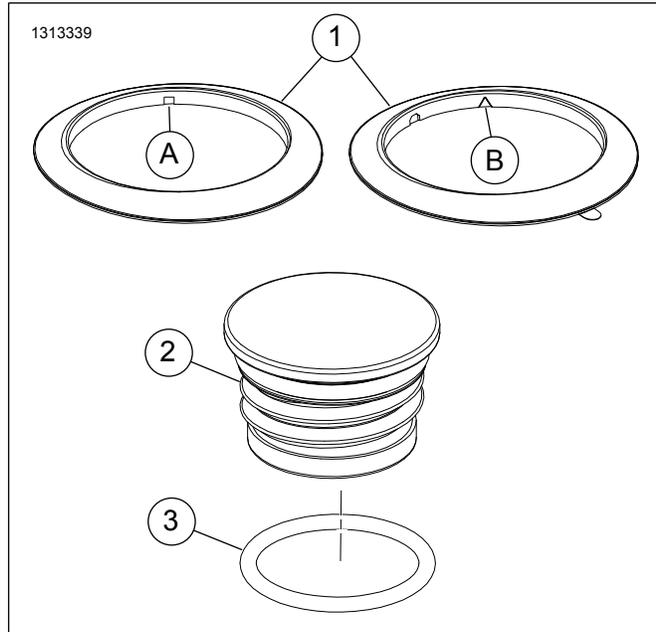
Figura 4. Piezas de servicio: Kit de tapa de la gasolina montada
