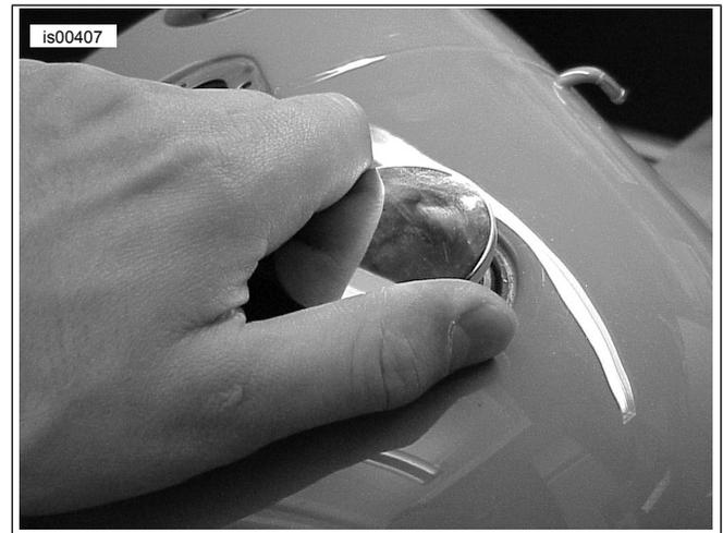
Figure 1. Visser le bouchon de remplissage de carburant
