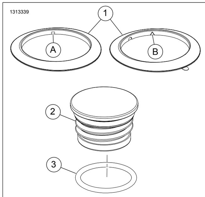
Abbildung 4. Ersatzteile: Kraftstofftankdeckelsatz bündig anbringen
