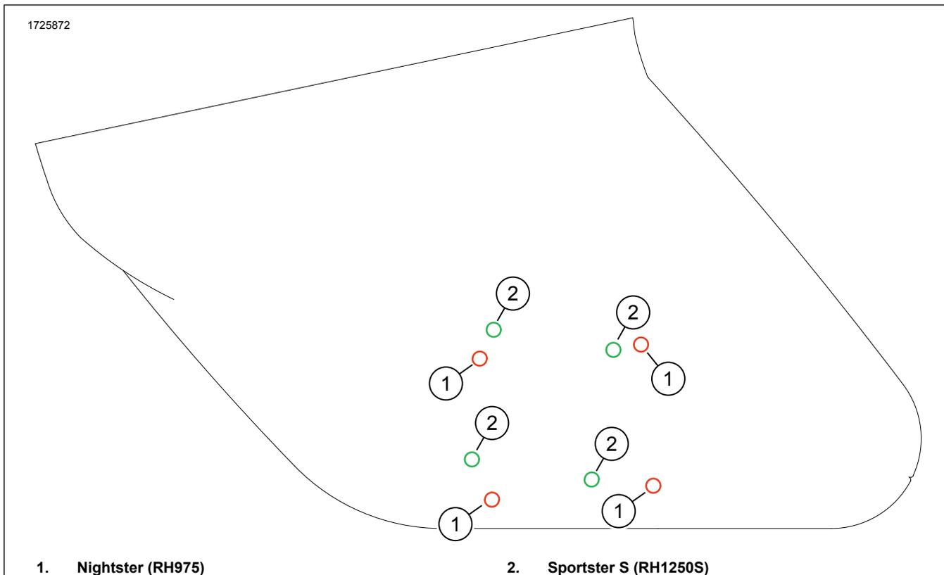
Figure 2. Emplacements des trous du support de montage (en regardant à l'intérieur)
