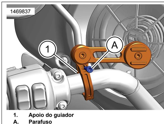
**Figura 2. Instalação do suporte para telefone no braço esquerdo do guiador**
