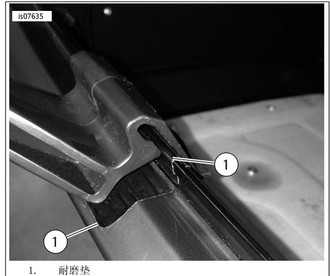
图1。在Tour-Pak上安装耐磨垫
