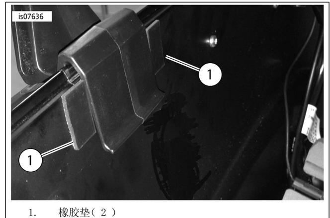
图2。在Tour-Pak内侧安装橡胶垫
