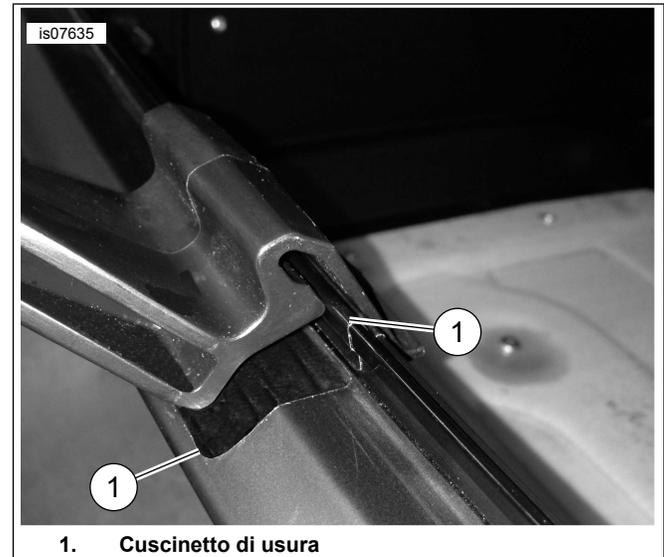
Figura 1. Installare il cuscinetto di usura sul Tour-Pak
