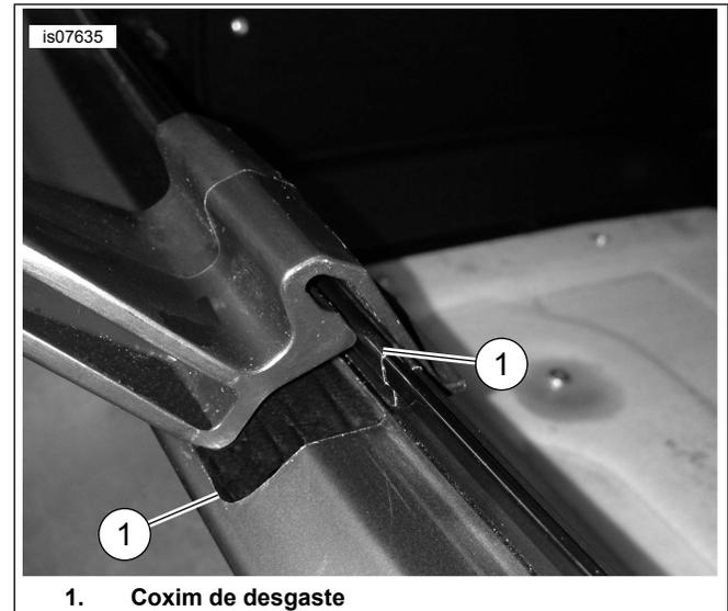
Figura 1. Instale o coxim de desgaste no Tour-Pak
