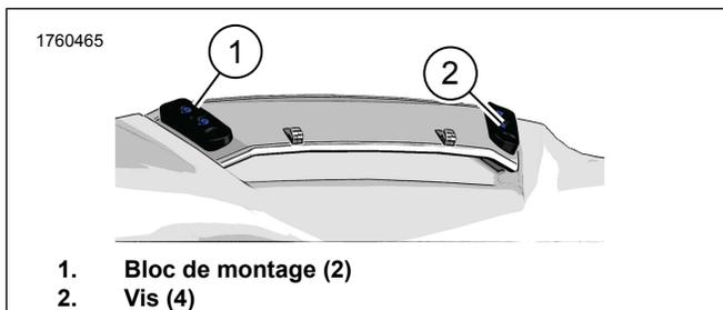
Figure 2. Retirer les blocs de montage
