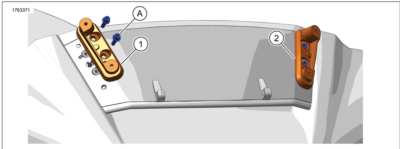
Figure 1. Contenu du kit : Blocs de montage de grand pare-brise
