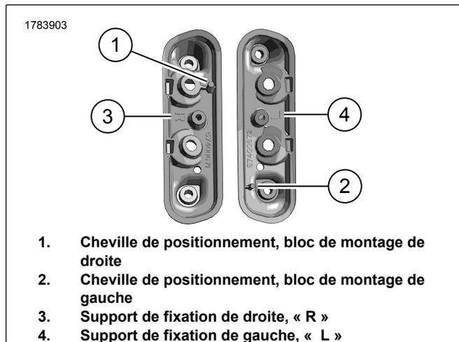
Figure 3. Emplacements des chevilles de positionnement des blocs de montage de droite / de gauche
