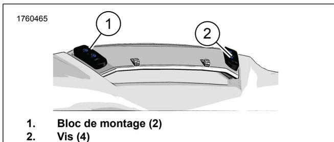
Figure 2. Retirer les blocs de montage
