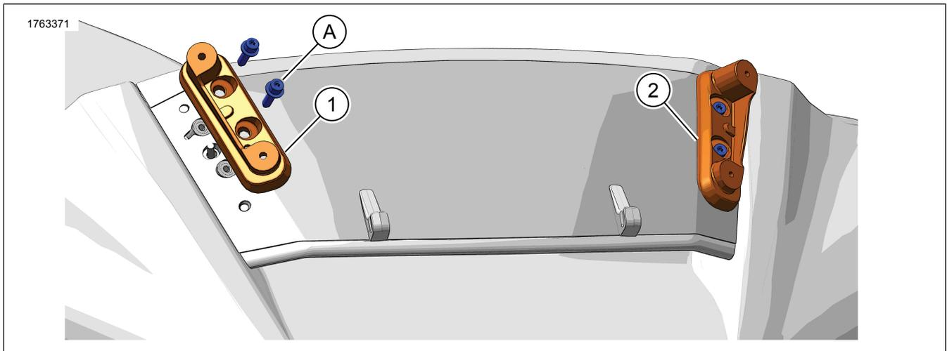
Figure 1. Contenu du kit : Blocs de montage de pare-brise haut
