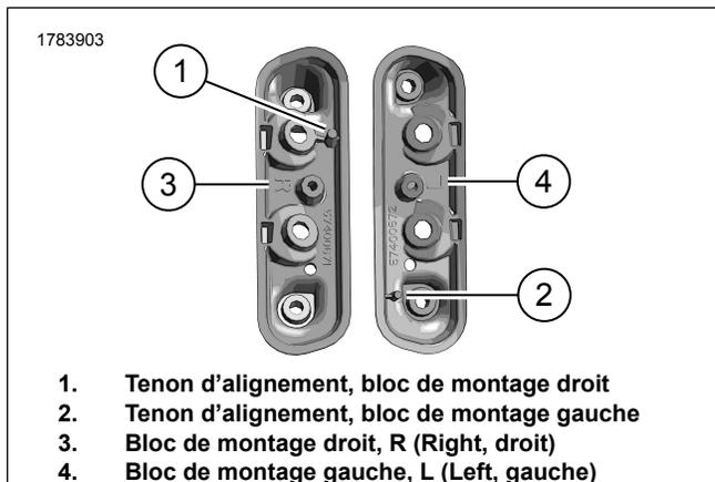
Figure 3. Emplacement des tenons d'alignement des blocs de montage droit/gauche
