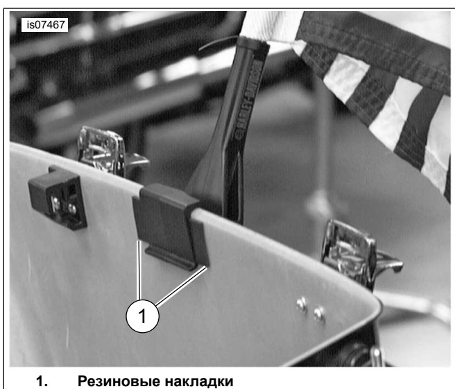
Рисунок 2. Резиновые накладки, установленные с внутренней стороны заднего кофра Tour-Pak
